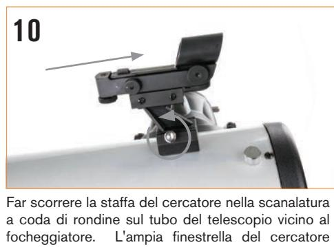
Far scorrere la staffa del cercatore nella scanalatura a coda di rondine sul tubo del telescopio vicino al focheeggiatore. L'ampia finestrella del cercatore dovrebbe essere rivolta verso la parte anteriore del telescopio. Fissare la staffa serrando la vite sulla scanalatura a coda di rondine.
