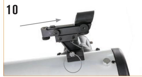
Faites glisser la barre à queue d'aronde dans le rail situé sur le dessus de la monture et serrez la molette à main située sur le dessous du rail pour fixer le télescope en place.
