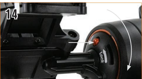
Pour retirer le support, appuyez sur le bouton de libération orange et faites tourner le support dans le sens des aiguilles d'une montre jusqu'à ce que la monture à baïonnette se libère.
