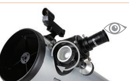
Nehmen Sie den Objektivdeckel vorne am Teleskop ab. Schauen Sie zum Beobachten durch das Okular, wie oben dargestellt. Stellen Sie das Bild scharf, indem Sie die Knöpfe unterhalb des Fokussierers drehen.
