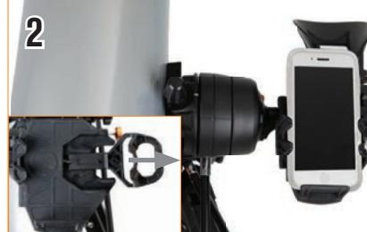
Öffnen Sie den federgespannten Schieber oben am Telefondock durch Ziehen und setzen Sie das Telefon so in die Halterung ein, dass es bündig mit der unteren Lippe der Telefonhalterung abschließt. Lassen Sie den Schieber langsam los, um das Telefon zu sichern. Die meisten Telefone passen mit angebrachter Hülle in das Dock. Möglicherweise müssen Sie jedoch Ihre Telefonhülle entfernen, wenn sie besonders sperrig ist oder nicht in die Klemme passt (z. B. Schutzhüllen im Folio-Stil).
