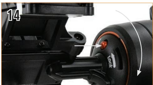
Drücken Sie zum Entfernen des Docks den orangefarbenen Entriegelungsknopf und drehen Sie das Dock im Uhrzeigersinn, bis sich der Bajonettverschluss löst.
