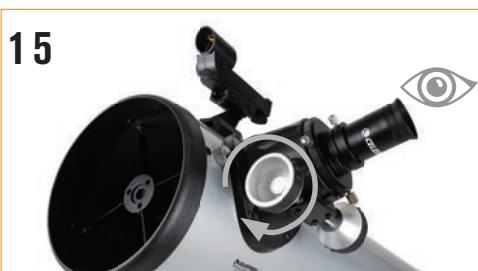
Retirez le capuchon de la lentille de l'avant du télescope. Pour effectuer l'observation, regardez dans l'oculaire comme illustré ci-dessus. Faites le point sur l'image en faisant tourner les molettes sous le système de mise au point.
