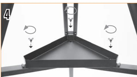
Coloque la bandeja de accesorios sobre el soporte central y alinee los tres agujeros. Inserte los tres tornillos a través de la parte superior del soporte de la pata y enrósquelos en la bandeja.
